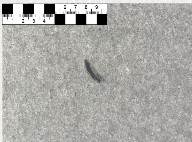
Inclusion de marne dégradée (peut-être mastiquée par un spécialiste)
