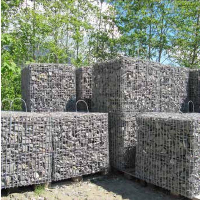
Werkseitig montierte, verfüllte und verdichtete Steinkörbe:
