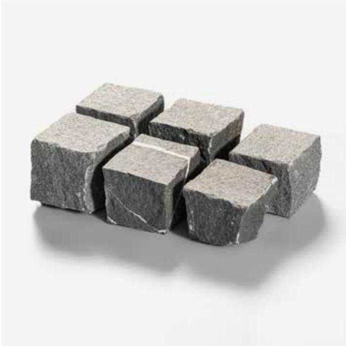
Der jüngste Pflasterstein aus dem Hause Guber. Mit diamantgefräster und geflammter Oberfläche für maximale Ebenheit sowie gerichteten Kanten für besonders enge Fugen. Insbesondere geeignet für ein Versetzen als Bogenpflasterung, welche durch die wechselnde Ausrichtung der Fugen ein besonders ruhiges befahren ermöglicht. Dieser Stein lässt bezüglich hindernisfreiem Bauen keine Wünsche offen.
