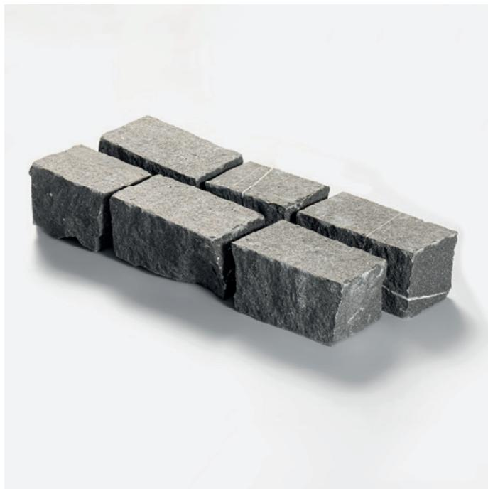
Der jüngste Pflasterstein aus dem Hause Guber. Mit diamantgefräster und geflammter Oberfläche für maximale Ebenheit sowie gerichteten Kanten für besonders enge Fugen. Um ein besonders ruhiges Fahrerlebnis zu erreichen, empfehlen wir die Ausrichtung der Fugen in einem leicht geneigten Winkel zur Hauptfahrrichtung. Dieser Stein lässt bezüglich hindernisfreiem Bauen keine Wünsche offen.
